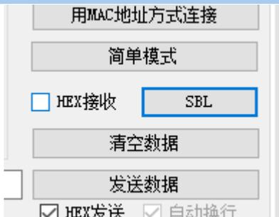
在使用支持 SBL 的 2541 透传模组时，可以用软件对模组进行串口升级，同样需要将模组的 VCC、GND、RX、TX 连接好，WAKEUP 拉低，然后选择正确的串口和波特率（一般为 115200）。点击 SBL 按钮
