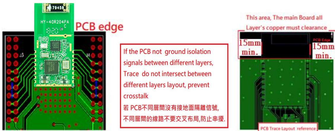
模块焊装在主板时须注意:天线周围及各层铜箔须净空,模块天线需放在主板的边缘.
